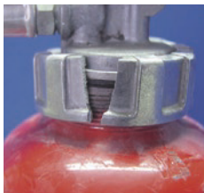
× キャップの破損
