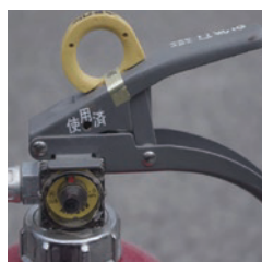
× 表示装置の脱落
