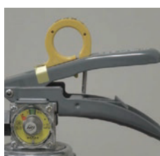
× レバー支えの脱落
