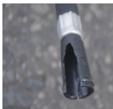
× ノズルの破損
